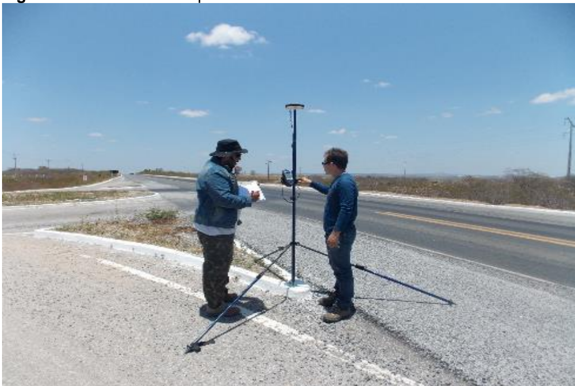
Figura 22: Coleta em Campo com Procedimento Estático.
