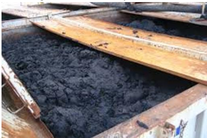
Figura 16: Foto do lodo de esgoto armazenado nas caçambas receptoras do resíduo gerado no processo de desidratação na ETE.
