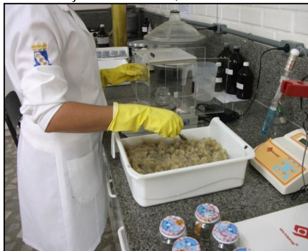
Figura 14- Pesagem em balança semi analítica dos resíduos nos frascos para fermentação. LABBIO II, UERN.
