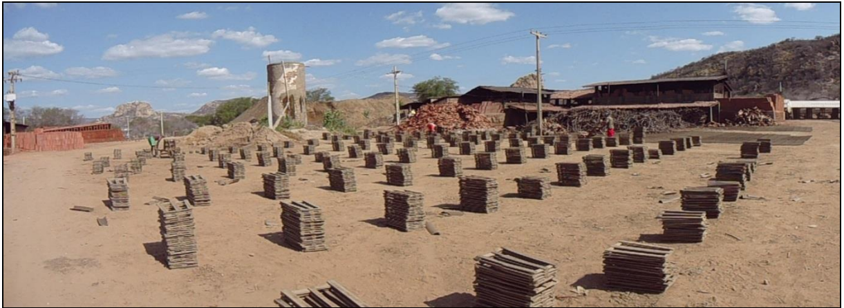
Figura 18 – Vista parcial do processo de secagem natural em indústria ceramista de Carnaúba dos Dantas-RN. 2013.
