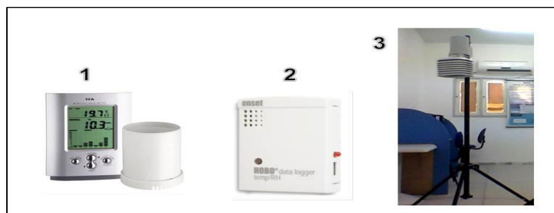
FIGURA 8 – Instrumentos para o monitoramento hidroclimático na região serrana de Portalegre, Martins e adjacências. 1 – Pluviômetro digital TFA; 2 – Termohigrômetro digital HOBO data logger; 3 – Instrumentação montada em uma base metálica (tripé)
