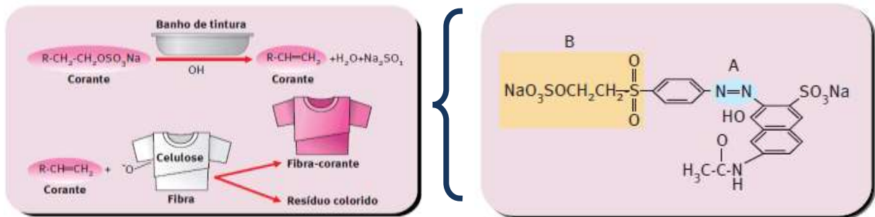
FIGURA 2.2: Exemplo da estrutura molecular de um corante reativo que contém a função azo como cromóforo e o sulfatoetilsulfanila como grupo responsável pela fixação à fibra de algodão, sendo A o cromóforo e B o grupo fixador.
