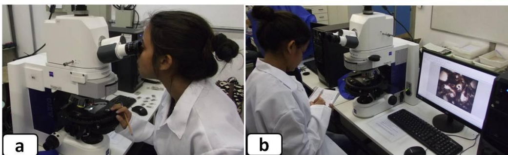
Figura 7 – Etapa de visualização no Laboratório de Paleontologia/UERJ: a) visualização das lâminas em microscópio petrográfico, b) fotografia das lâminas com auxílio da câmera acoplada ao microscópio.
