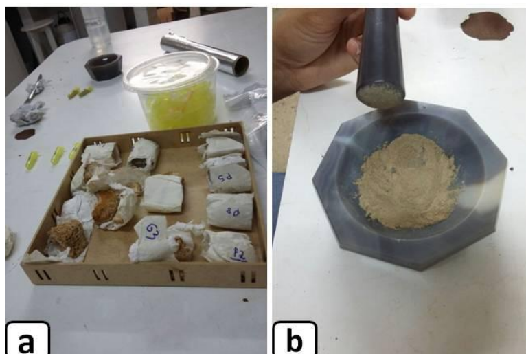
Figura 8 – Preparação do material para as análises de Difratoimetria e Fluorescência. a) seleção do material; b) trituração das amostras com almoforiz e pistilo de ágata.
