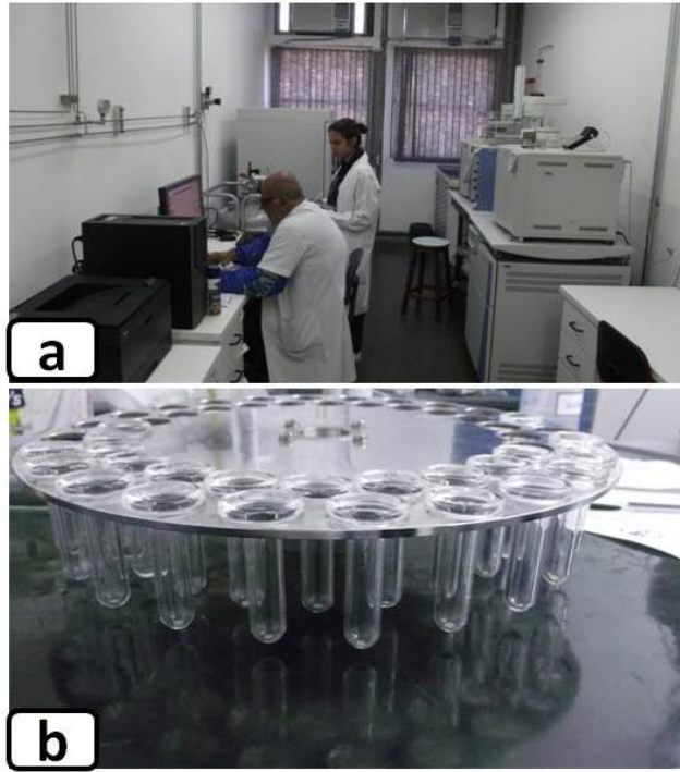
Figura 9 – Análise de isótopos no LGQM da UERJ. a) preparação da amostra e coleta de dados metodológicos; b) amostras inseridas separadamente na bandeja em vials.
