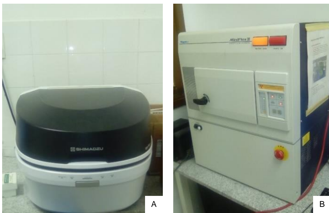
Figura 6: Aparelhos usados para as análises geoquímicas. A: Fluorescência de raios-X (EDX-7000); B: Difração de raios-X (XRD-600).
