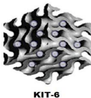
Figura 7. Representação da estrutura cúbica do material mesoporoso KIT-6. Fonte: Adaptado de (WEI et al. , 2010).
