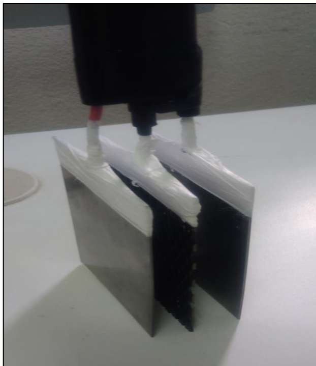
Figura 11. Eletrodos utilizados no tratamento eletroquímico dos efluentes da IBCC.
